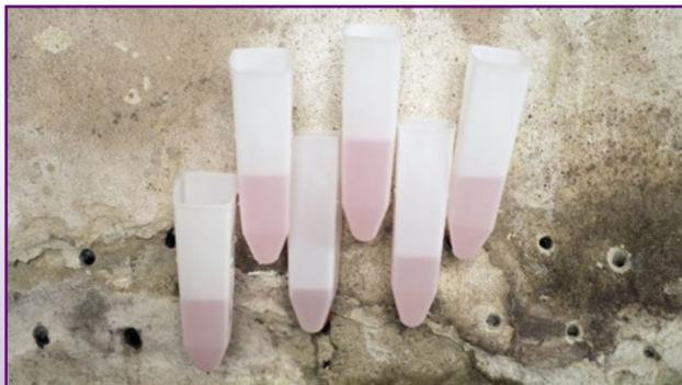
Das Injektionsprodukt auf Natrium-Silikat-Basis, welches eine **permanente Barriere** gegen Wasser und andere Flüssigkeiten bilden und zudem verschiedene **Substrate verfestigen** kann.
